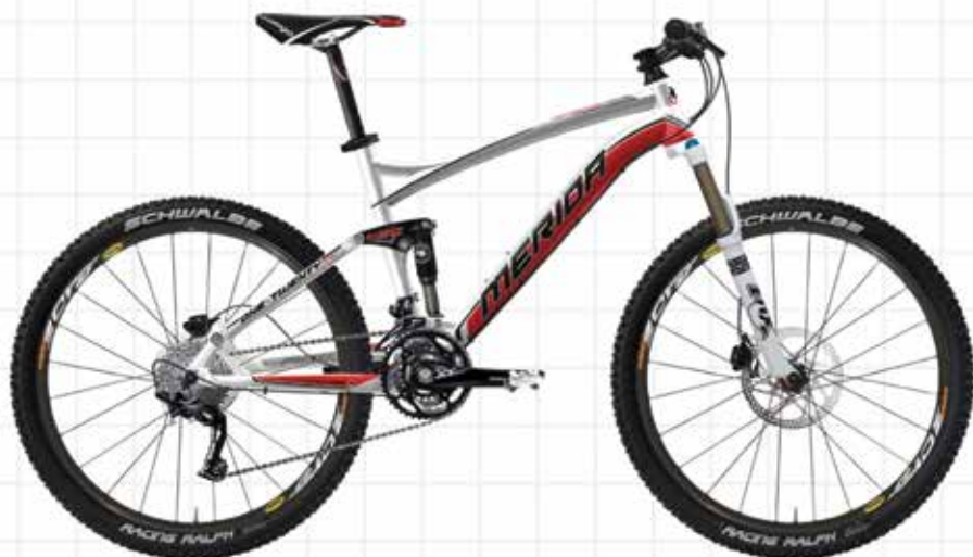
ONE TWENTY XT-M [30 นิ้ว] เฟรม ONE-TWENT Pro Lite ตะเข็บโช๊ค FOX Float F32 CTD Evo 120mm Taper มือเบรค Shimano XT (3x10) ดันมี Shimano XT ลับจาน Shimano XT ชุดจานหน้า Shimano XT 42-32-24T เฟือง Shimano HG81 11-36T โซ่ KMC X10 10S เบรค ดิสก์เบรค Shimano SLX แชนดัลคย MERIDA Pro OS ยาน Prologo Kappa Evo ชุดล้อ Mavic Crossride Disc ยางนอก Schwalbe Racing Ralph 26x2.25 EVO ราคาตั้ง 92,000
