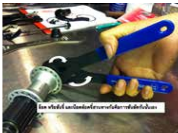
ลอค หรือ ขันจี้ และ น็อตลอค จี้ส่วนทาง กันคือการ ขันขันกัน นั่นเอง
