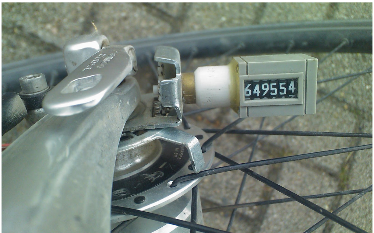
ภาพที่ 3.5 เครื่องนับรอบ Jones Counter ภาพจาก fruehlingslauf-rot.de
