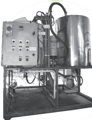
เครื่องต้นแบบผลิตน้ำมัน ไบโอดีเซล ขนาด 150 ลิตร ของมหาวิทยาลัยเชียงใหม่
