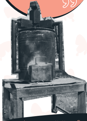
๖๖ เตาเผาผ่านขนาดกะทัดรัดของโรงเรียนวัดไพรใหญ่ ใช้เวลาเผาเพียง 7-8 ชั่วโมงเท่านั้น แถมยังใช้แก๊สน้อย เหลือเชื่อ
