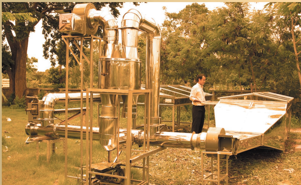
รูปที่ 6 การอบแห้งสมุนไพรโดยใช้ระบบอบแห้งด้วยพลังงานแสงอาทิตย์ร่วมกับกระบวนการดูดซับความชื้นอากาศอบแห้งต้นแบบที่โรงงานของกลุ่มแม่บ้านสหกรณ์นิคมปากท่า อ.ปากท่า จ.อุดรธานี
