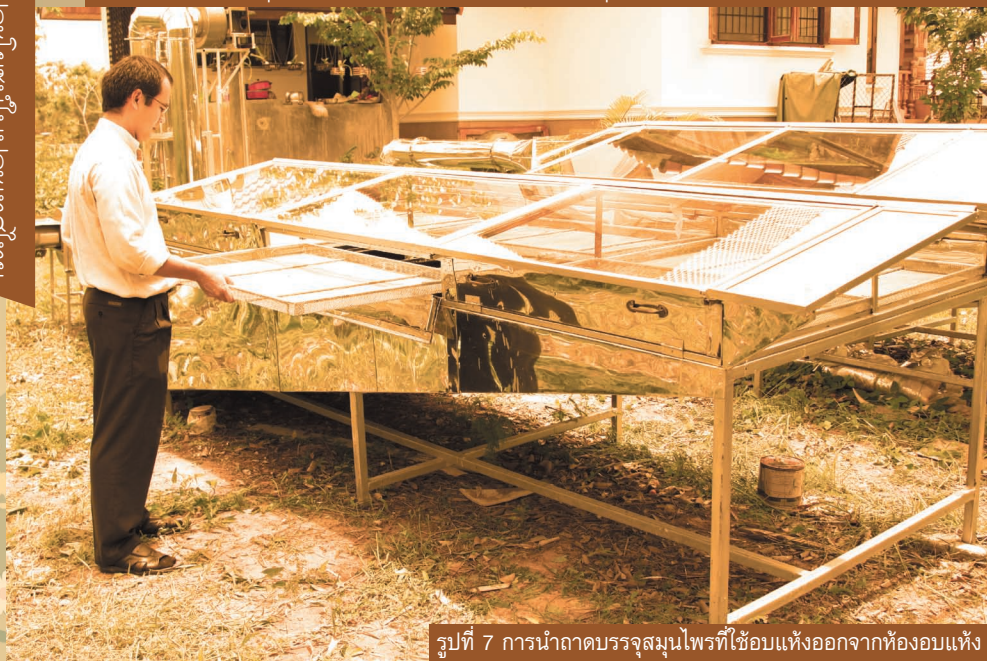
รูปที่ 6 การอบแห้งสมุนไพรโดยใช้ระบบอบแห้งด้วยพลังงานแสงอาทิตย์ร่วมกับกระบวนการดูดซับความชื้นอากาศอบแห้งต้นแบบที่โรงงานของกลุ่มแม่บ้านสหกรณ์นิคมปากท่า อ.ปากท่า จ.อุดรธานี
