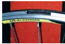
ขอบล้อบริเวณด้านข้าง เมื่อขอบล้อบาง จะแตกแบบนี้
