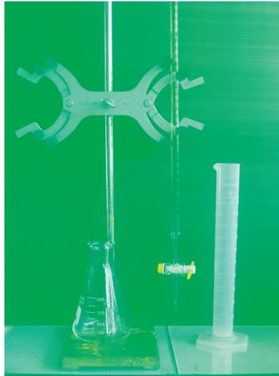
ภาพประกอบที่ 13 เครื่องแก้วที่ใช้ในการไทเทรต (ขวดรูปชมพู่ บิวเรตและกระบอกลดแรงดัน เรียงจากซ้ายไปขวา)
